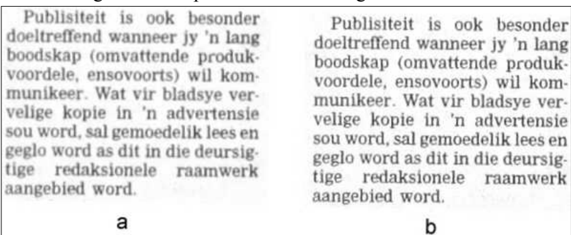
Beeld 2 – Vergrote deel van 'n halwe koerantbladsy digitaal gefotografeer teen (a) 2.5 Mpel en (b) 4 Mpel
